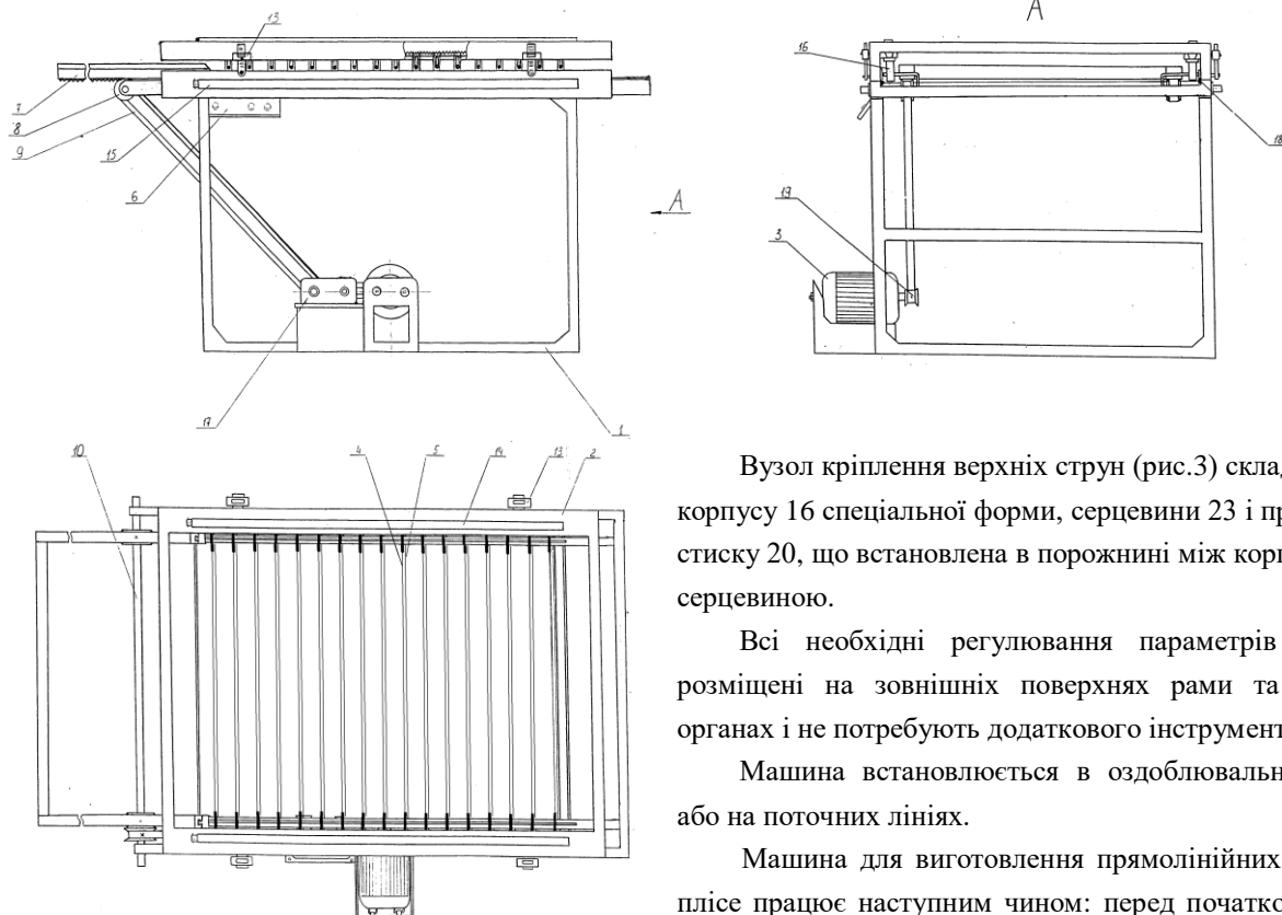
Рисунок 2. – Машина для виготовлення паралельних складок-плісе. Вид загальний
